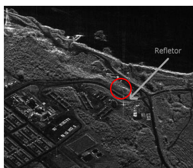
Figura 3 – Refletor destacado como ponto de amarração
