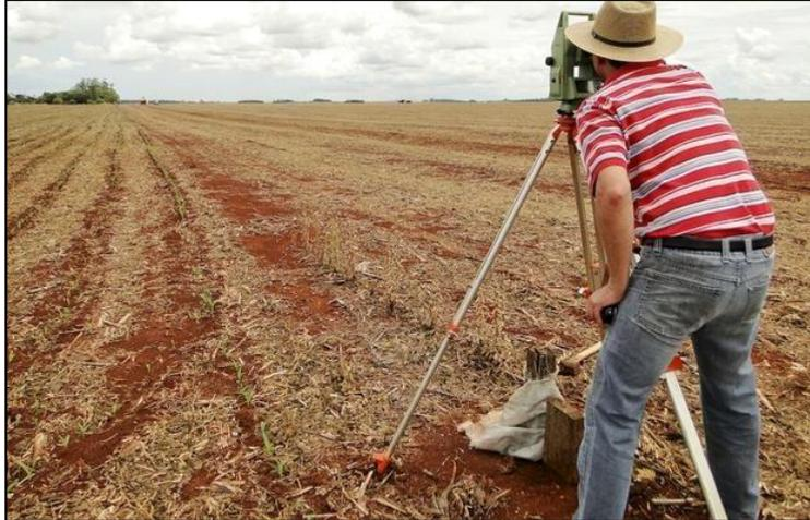
**Figura 3** - Levantamento de campo com estação total.
