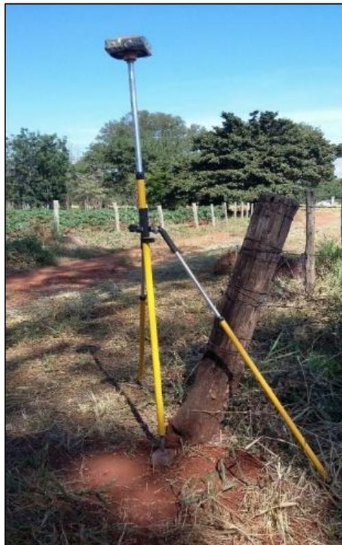
**Figura 4** - Levantamento de campo com GPS L1/L2.
