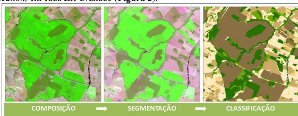
**Figura 2** – Resultado do Processo de Composição, Segmentação e Classificação no Arcgis.
