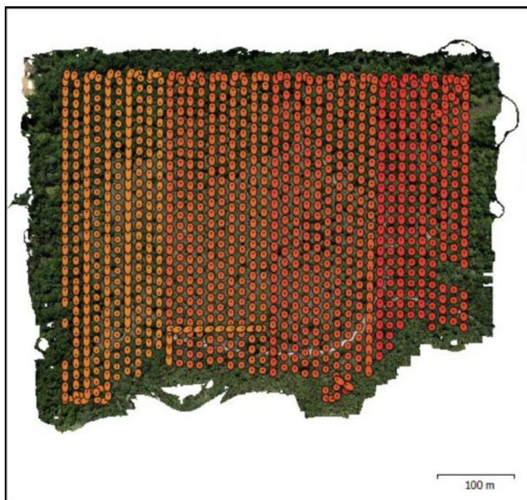
Figura 2. Trajeto do levantamento aerofotogramétrico realizado pelo RPAS.
