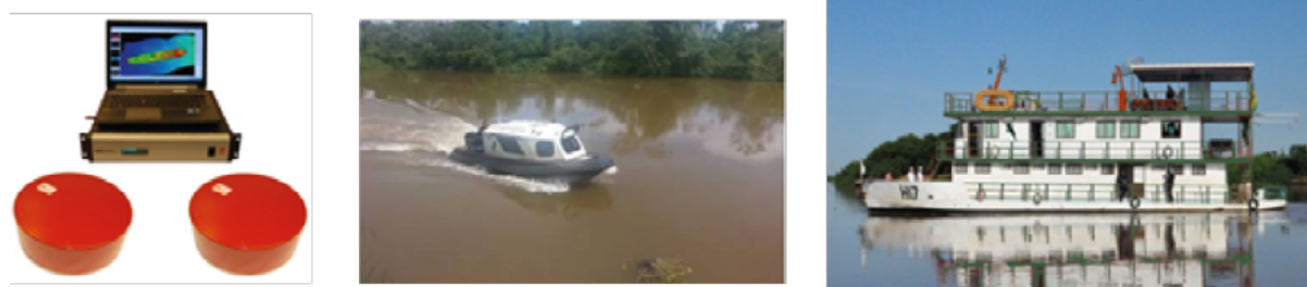
Figura 3. À esquerda, ecobatímetro multifeixe EM 2040 Kongsberg dual head . No centro, lancha de sondagem equipada com o sistema multifeixe. À direita, embarcação de apoio: Navio Hidroceanográfico Fluvial Caravelas.
