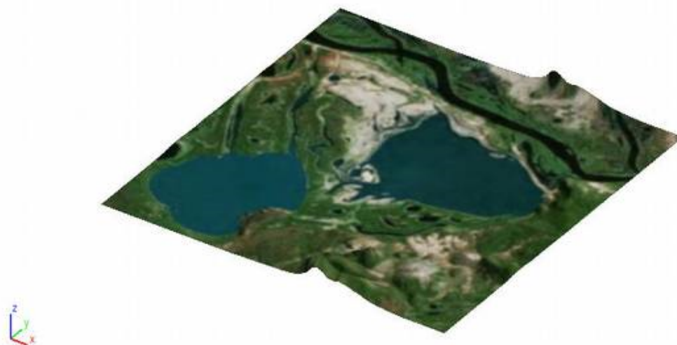
Figura 6. Modelo básico tridimensional combinando DEM em relevo com imagem Bing Fonte: Elaborada pelos autores, 2016
