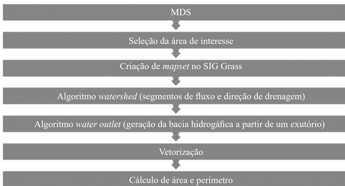
Figura 2. Fluxograma para delimitação de Bacia Hidrográfica pelo QGIS 2.14.0 (QGIS Development, 2015).
